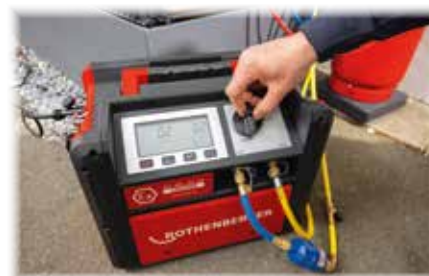
Funkcija samočišćenja za potpuno pražnjenje rekuperatora
