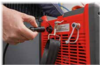
Sigurno povezivanje napojnog kabla
